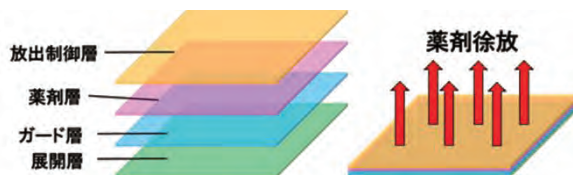
図 1 シート型薬剤徐放デバイスの構造
