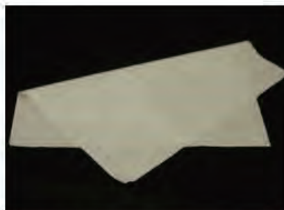
癒着防止シートの外観, SEM像 100×100mm, 0.1mm厚
